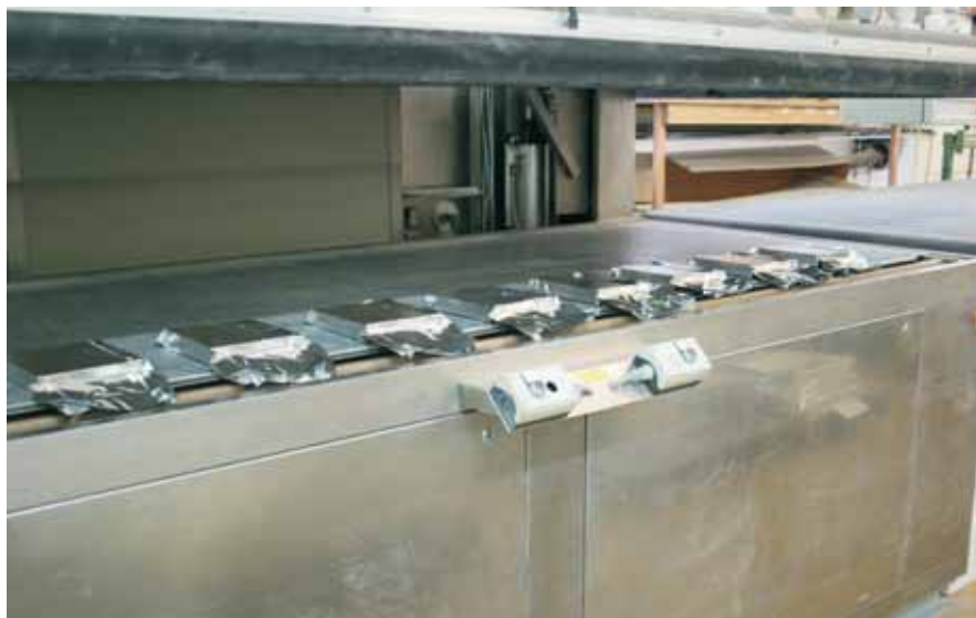
Čerpání vzduchu - evakuace ve vakuovém zařízení
