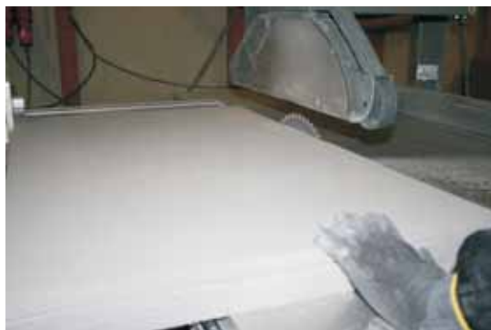
Rozměrově přesné přiřezávání jádrové desky z pyrogenní kyseliny křemičité
