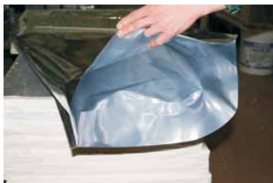
Výroba třístranně uzavřeného vaku z folie s vysokou bariérovou schopností
